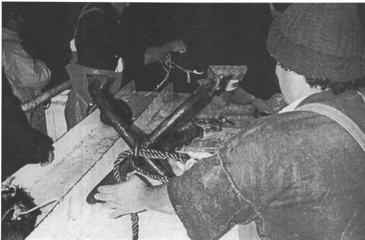
FOTO 2. LANZAMIENTO DEL ANCLA DE FONDO, SE APRECIA EL AMARRE DE LA RETENIDA Y LA CALA.
