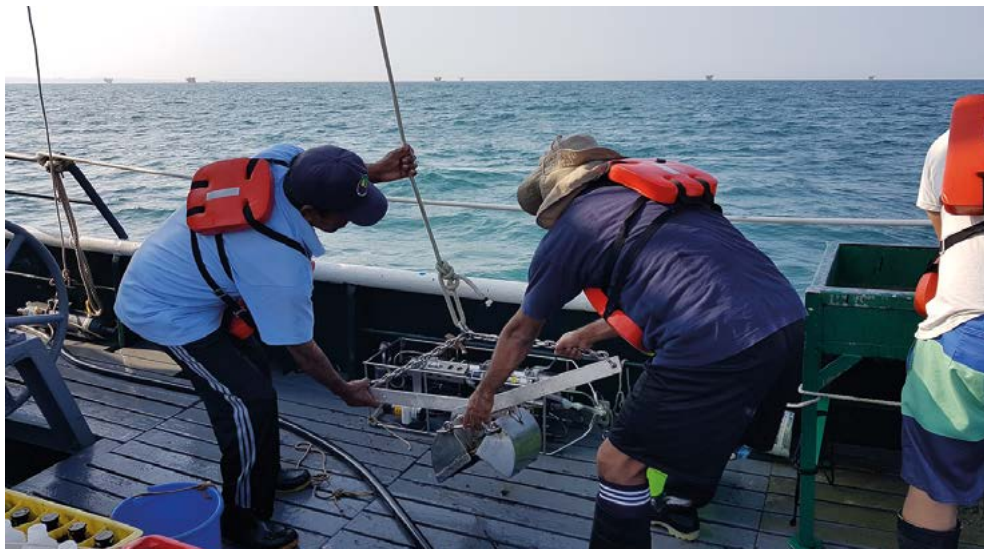
Figura 12.- Lanzamiento de draga para colecta de sedimento marino y estudio de macrobentos, Línea Base Máncora, diciembre 2018
