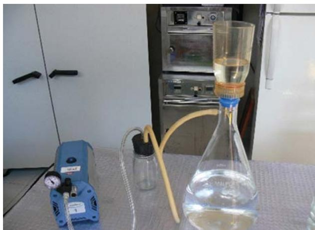
Figura 5.- Equipo de filtración
