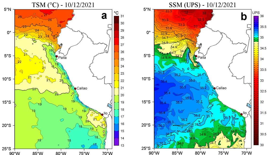
**Figura 2.** a) Temperatura superficial del mar (TSM, °C) y b) Salinidad superficial del mar (SSM) para el 10 de diciembre de 2021. Datos: OSTIA-UKMO-L4-GLOB-v2.0 (UK Met Office, 2012; Donlon et al, 2012) disponible en <https://podaac.jpl.nasa.gov/dataset/OSTIA-UKMO-L4-GLOB-v2.0> para (a) y Hybrid Coordinate Ocean Model v. GOFS 3.1 (HYCOM; Halliwell et al., 1998; 2000; Bleck, 2001) para (b).
