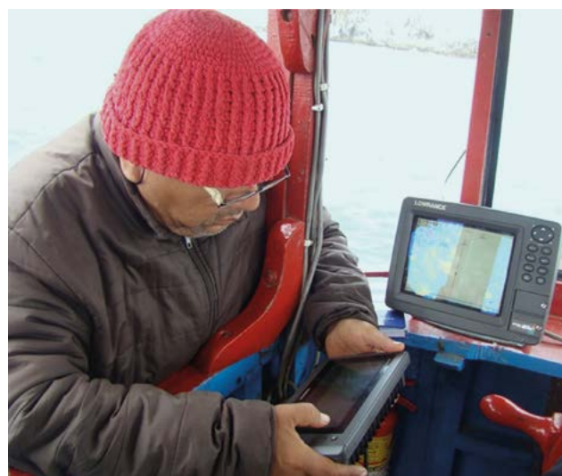
Figura 7.- Ecosonda portátil, utilizada en el Estudio para la Zonificación de invertebrados marinos bentónicos comerciales. Islote Don Martín, octubre 2016
