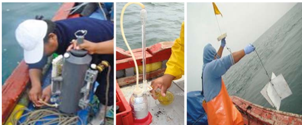
Figura 7.- Toma de muestra en botella Niskin, Titulación de Oxígeno y lanzamiento de derivadores para corrientes
