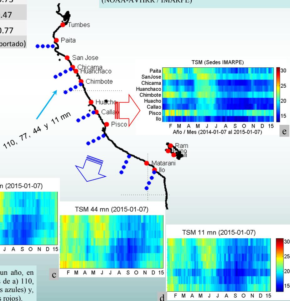
Figura 5. Diagramas Hovmöller de TSM (°C) durante un año, en puntos de monitoreo de información satelital a distancias de a) 110, b) 77, c) 44, d) 11 millas náuticas (mn) de la costa (puntos azules) y, e) en estaciones costeras registrados por IMARPE (puntos rojos).
