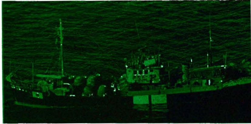
Fig. 1: Una embarcación dedicada a la colocación de nasas para el cangrejo "tanner", asignada al buque madre "Keiko Maru" coloca los aparejos al norte de la isla de Unimak. Una boya y bandera aparecen a popa. Pilas de nasas colocadas unas sobre otras están en la cubierta de pozos, mientras que las nasas completamente montadas están sobre la cola de abanico.
