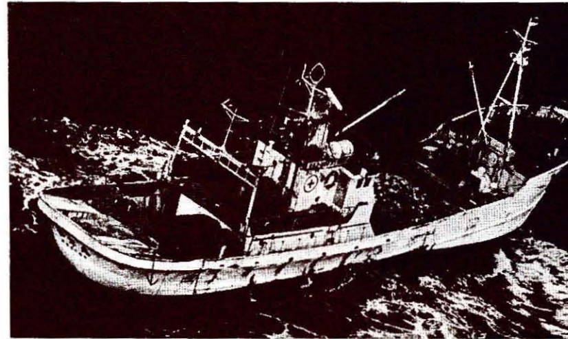
Fig. 2: Vista aérea de una embarcación japonesa accionando nasas para cangrejo de la variedad "tanner". Los cangrejos pueden verse estibados sobre la cubierta de pozos. Los palangres que transportan a las nasas adujados en la cola de abanico, con las nasas colocadas unas sobre otras, en una banda.
