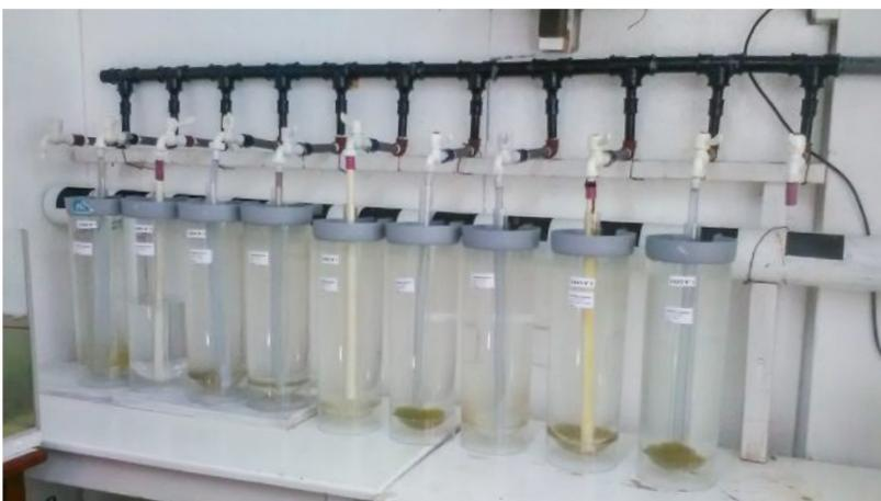
Figura 10. Batería de vasos tipo Chasse. Permiten mantener las ovas en movimiento lento y continuo mediante la recirculación del agua evitando la formación de masa en el fondo del vaso, la cual conllevaría la muerte del embrión.
