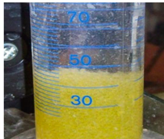
Figura 11. Probeta con ovas para el conteo, leer el volumen exacto.
