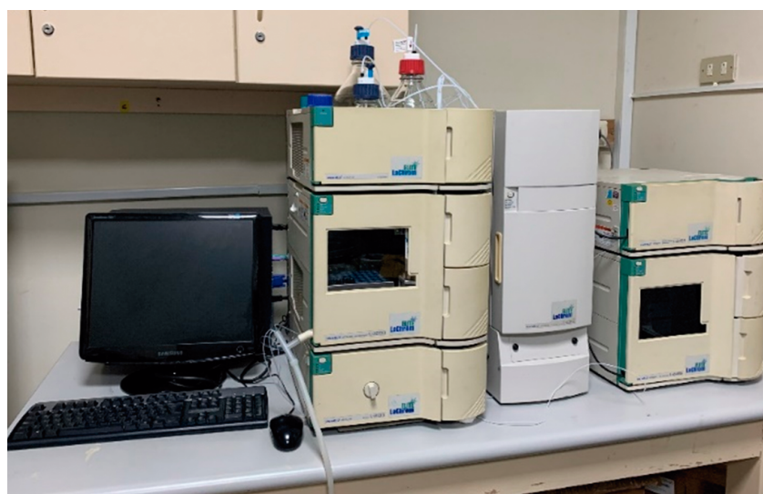
Figura 2.- HPLC Hitachi LaChrom Elite
