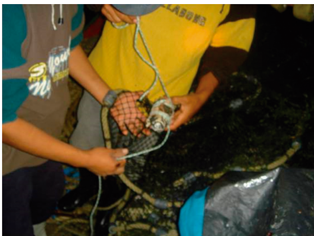
Figura 4.- Colocación de sensores en la red
