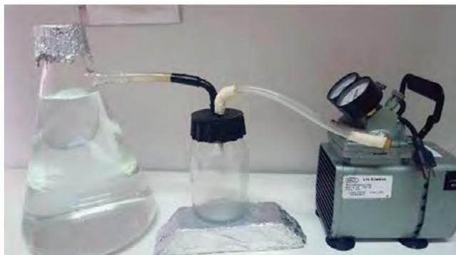
Figura 1.- Equipo de filtración y bomba de vacío
