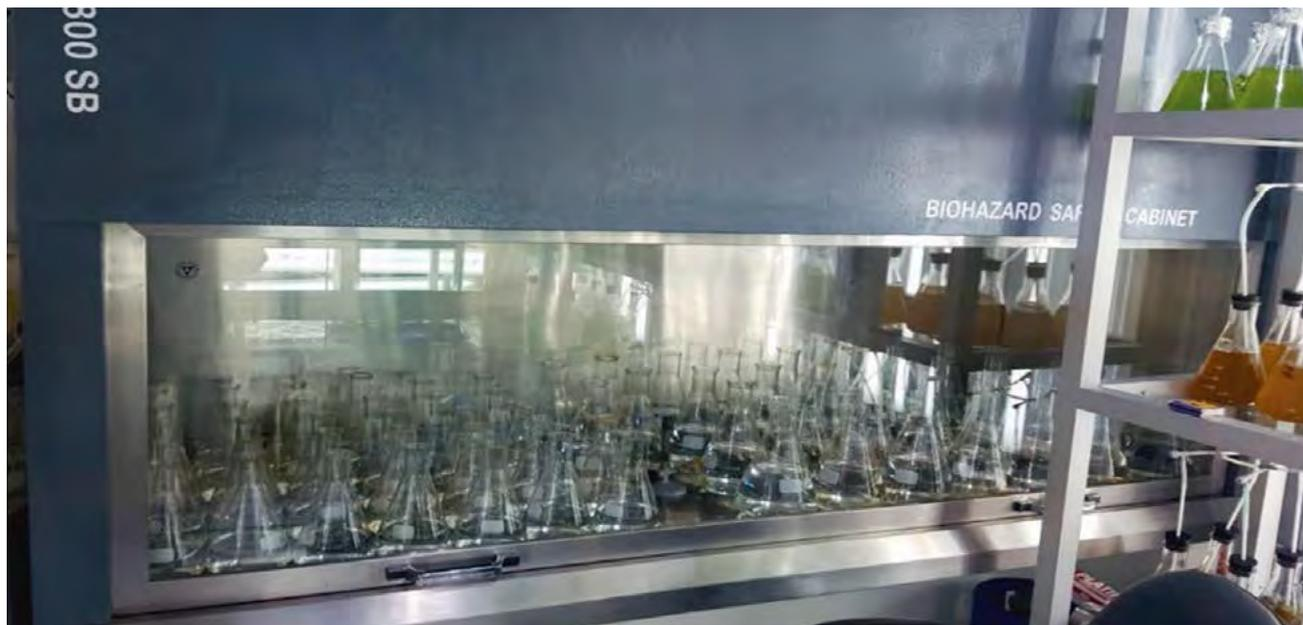
Figura 5.- Uso de la cámara de flujo laminar para la nutrición y esterilización de matraces previo siembra de microalgas
