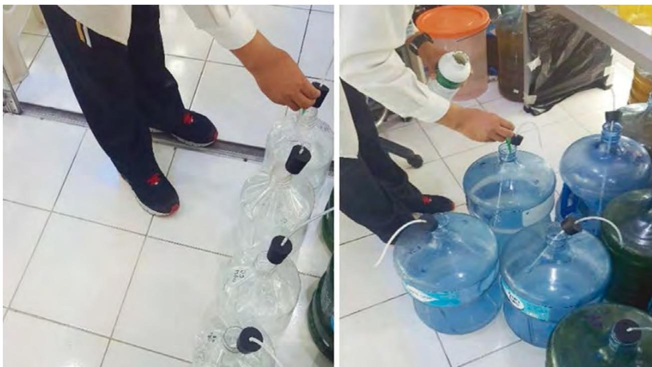
Figura 6.- Adición de nutrientes al agua previamente tratada con hipoclorito de sodio y tiosulfato
