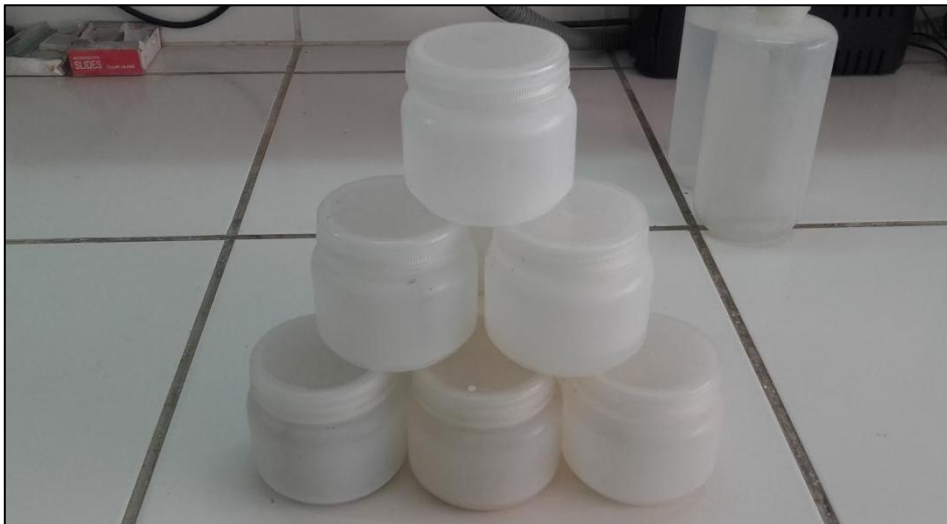
Anexo 14. Frascos de polietileno de 200 mL de capacidad utilizados para la conservación de la muestra.
