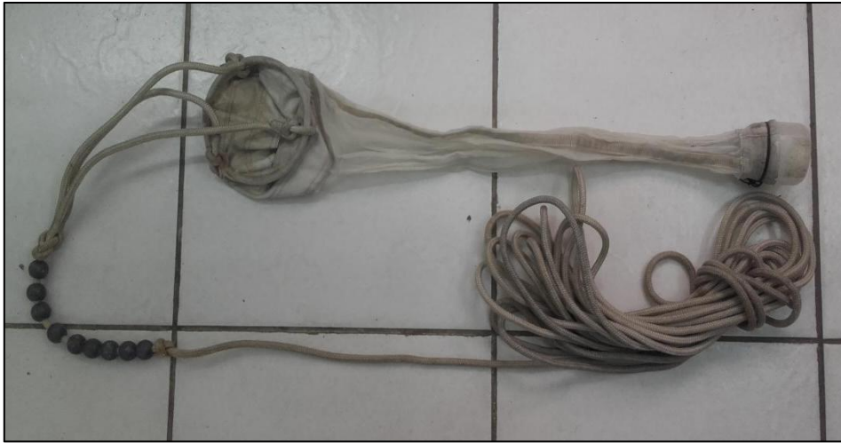
Anexo 13. Red de fitoplancton estándar de 75 µm de abertura utilizado en la recolección de la muestra.
