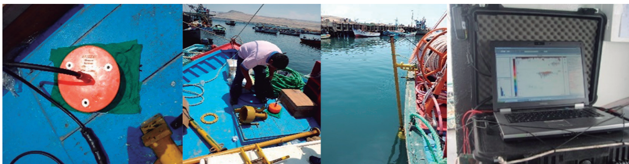
Figura 3.- Instalación de ecosonda científica marca SIMRAD Mod. EY 500
