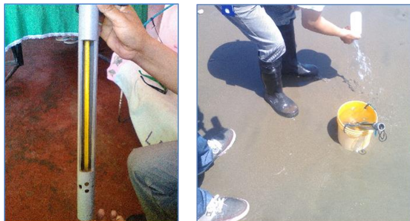
Figura N° 14: Termómetro y balde de plástico para la toma de datos de TSM in-situ.
