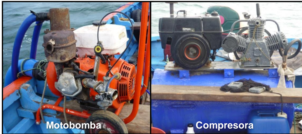
Figura 2.- Equipo utilizado para la extracción de “navaja”
