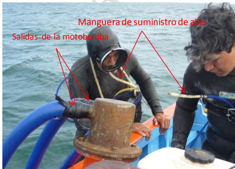
Figura 4.- Suministro del aire a los buzos por medio de mangueras.
