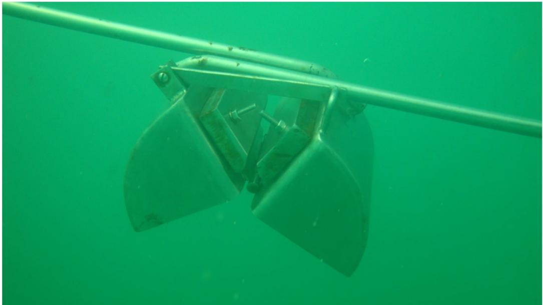
Figura 2.- Descenso de la draga Van Veen para la colecta de sedimentos. Bahía de Huarmey, 2006 al 2012.
