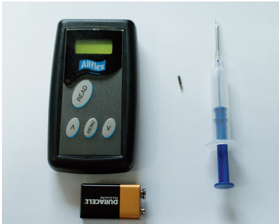
Figura N° 9. Escáner e identificador electrónico.
