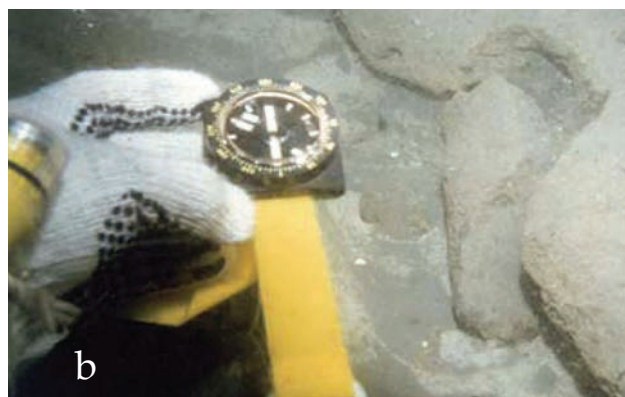
Figura 5.- a) Midiendo con un compás submarino en las estructuras sedimentarias (Ripples), la dirección de la corriente en el fondo frente a Ventanilla (Prof. 4 m). b) Midiendo la dirección de transporte en zona donde hay canales de erosión en sedimentos muy compactados o relictos (Prof. 15 m).
