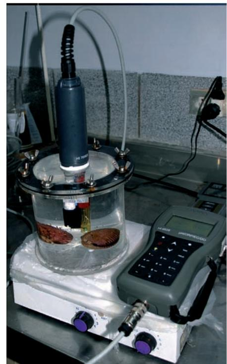
Figura 44.2. Cámara respirométrica y multiparámetro Hanna 9828.
