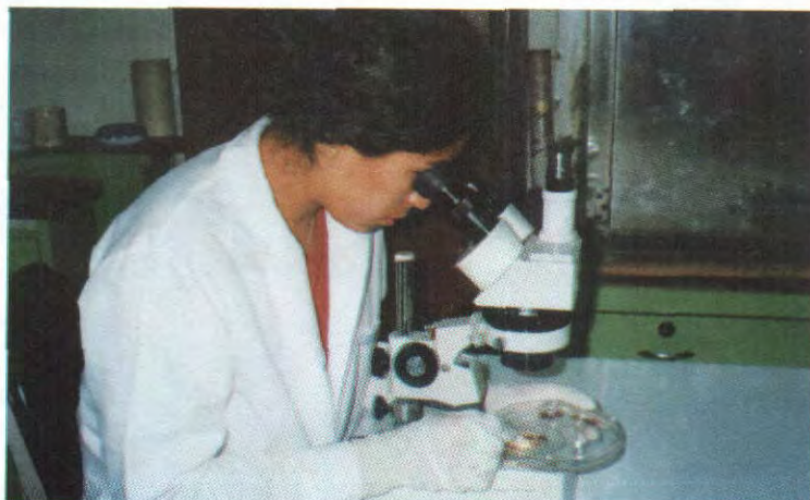
FIGURA 15. Lectura de sobrevivencia y separación de los organismos muertos durante las pruebas de toxicidad con juveniles de concha de abanico.
