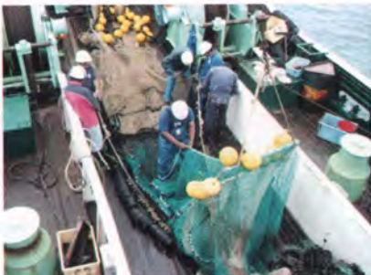
Figura 6.1.- Disposición del DEJUPA en la red.
